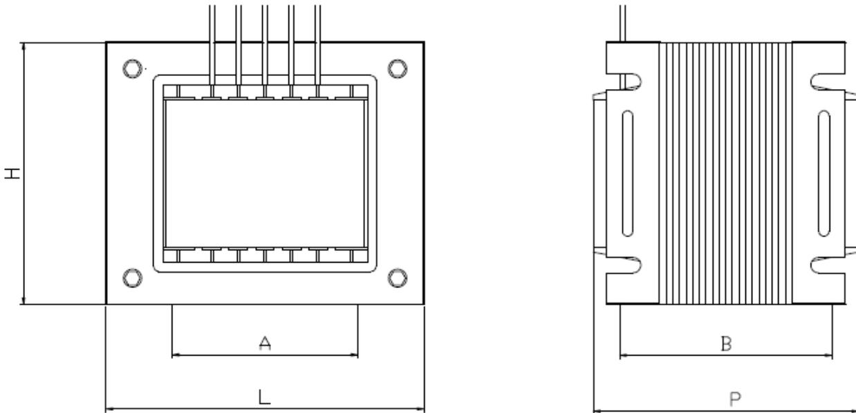
**Dati tecnici :** 4-8 ohm e uscita 70-100 V
