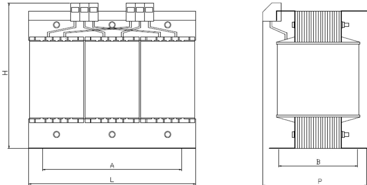
**Dati tecnici :** Ingresso 400 V a 50/60 Hz e Uscita 0-230 V
