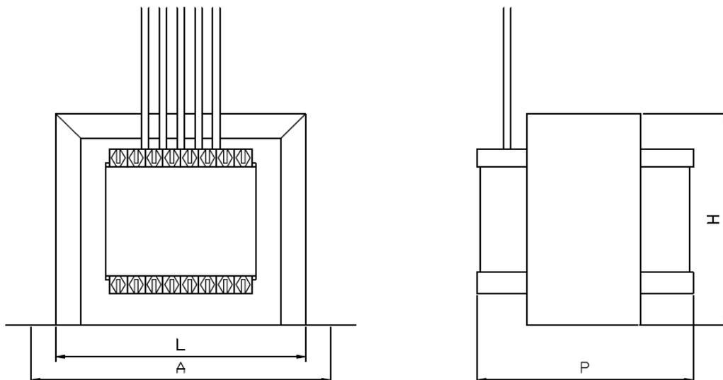
**Dati tecnici :** Ingresso 230-400 V a 50/60 Hz e Uscita 24 V
