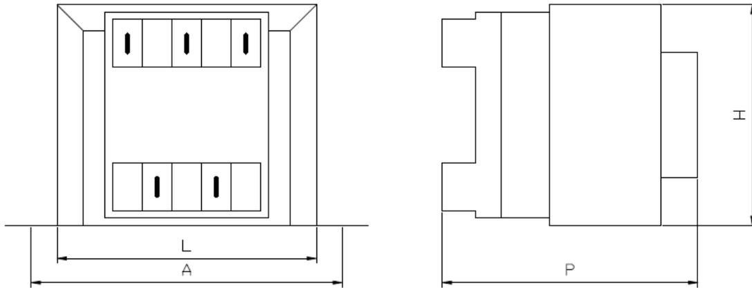
**Dati tecnici :** Ingresso 230-400 V a 50/60 Hz e Uscita 24 V
